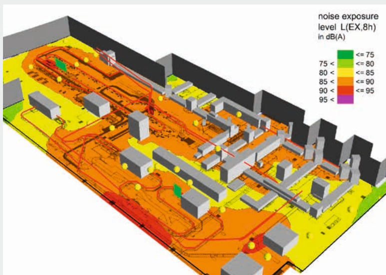
Lärmexpositionspegel in einer Werkhalle
