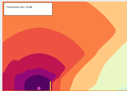
Das linke Bild zeigt die nach ISO 9613-2:2024 berechnete Abschirmung einer Wand mit einem unendlichen Transmissionsverlust. Das mittlere Bild zeigt die Ergebnisse mit einem angenommenen Transmissionsverlust von 10 dB, und das rechte Bild zeigt die Differenz zwischen den beiden Berechnungen (skaliert in 1-dB-Schritten).
